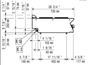
Electrical inlet (power) FΩ Equipotential screw
